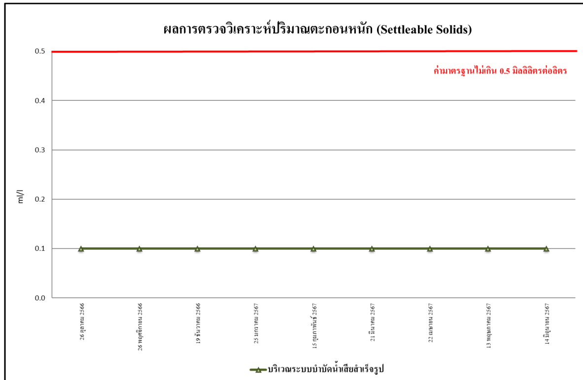
รูปที่ 4.4-54 เปรียบเทียบผลการตรวจวิเคราะห์ปริมาณของตะกอนหนัก (Settleable Solids) บริเวณระบบบำบัดน้ำเสียสำเร็จรูป ระหว่างเดือนตุลาคม 2566 - มิถุนายน 2567
